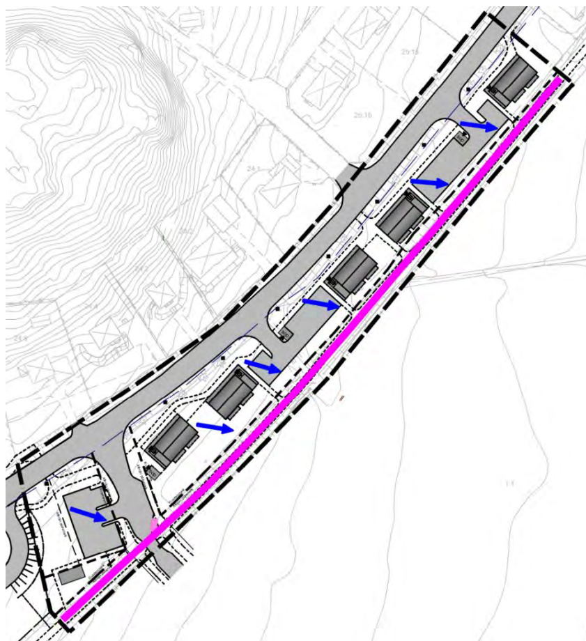
Figur 21. Generell flödesriktning visad med blå pilar. GC-väg markerad i magenta.
